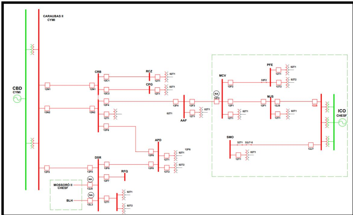
Figura 3 - Diagrama elétrico unifilar de linhas de subtransmissão do sistema elétrico do Estado do Rio Grande do Norte do regional que supre o município Venha Ver.
