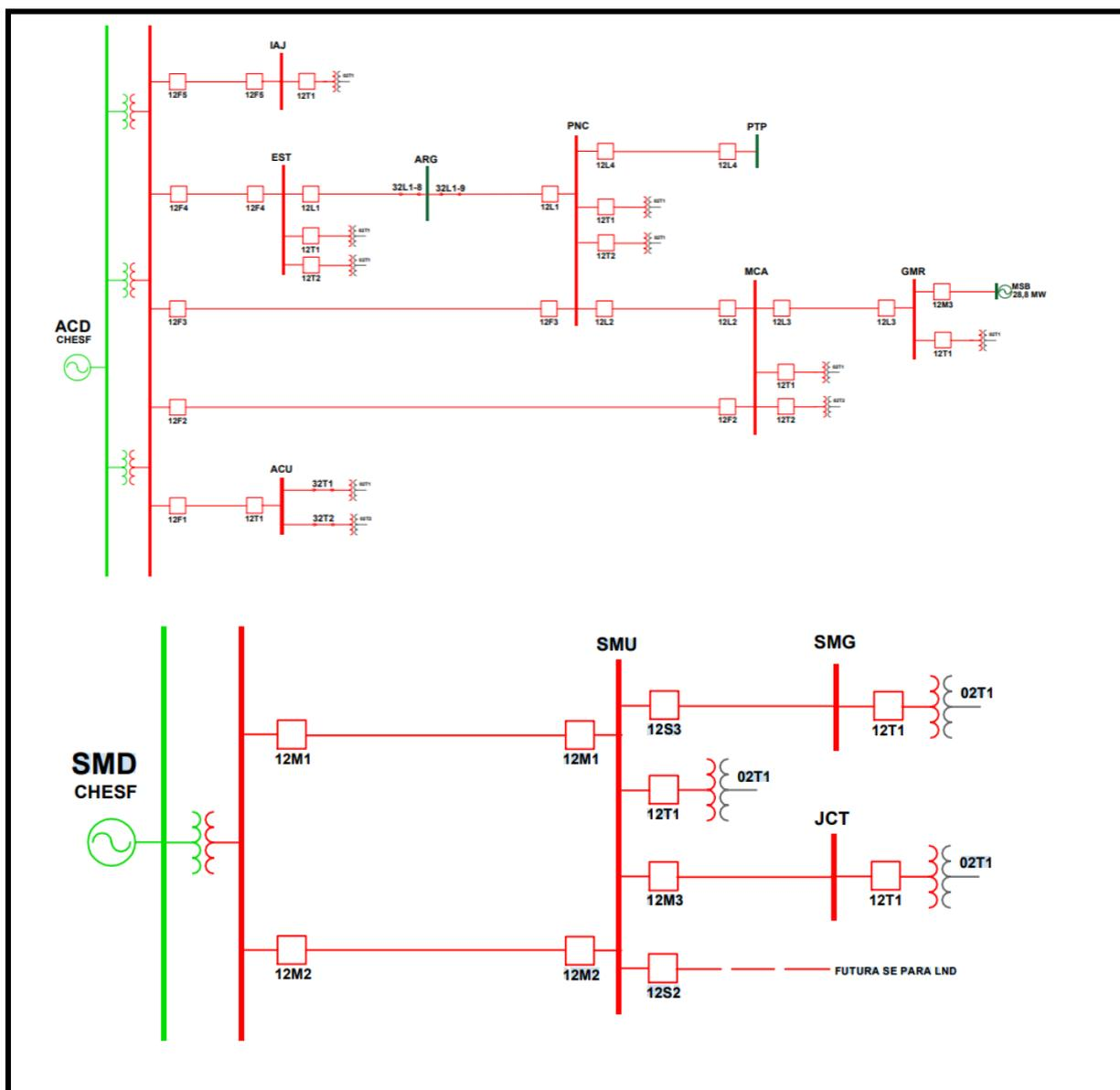
Figura 3 - Diagrama elétrico unifilar de linhas de subtransmissão do sistema elétrico do Estado do Rio Grande do Norte dos regionais que suprem o município de Angicos.
