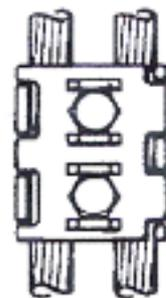
O conector aplicado na rede deve ser proteção suplementar para evitar penetração de água, utilizando, mastic, fita de auto-fusão com cobertura de fita isolante.
