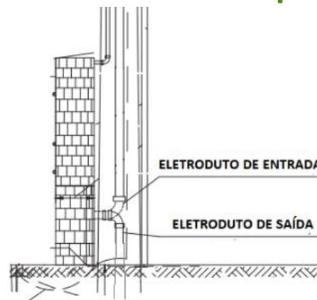
Para a caixa de modelo F4 a disposição dos eletrodutos de entrada e saída está **exclusivamente** na parte inferior da caixa, é possível ver projeção dos furos em : **FIGURA 12 ANEXO II - NOR.DISTRIBU-ENGE-0023.**
